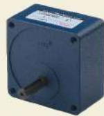
● 标准减速箱 型号: 70GK□H 速比: 1:3~180
