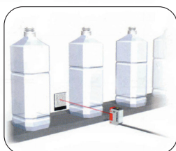
传送带上的PET瓶检测
